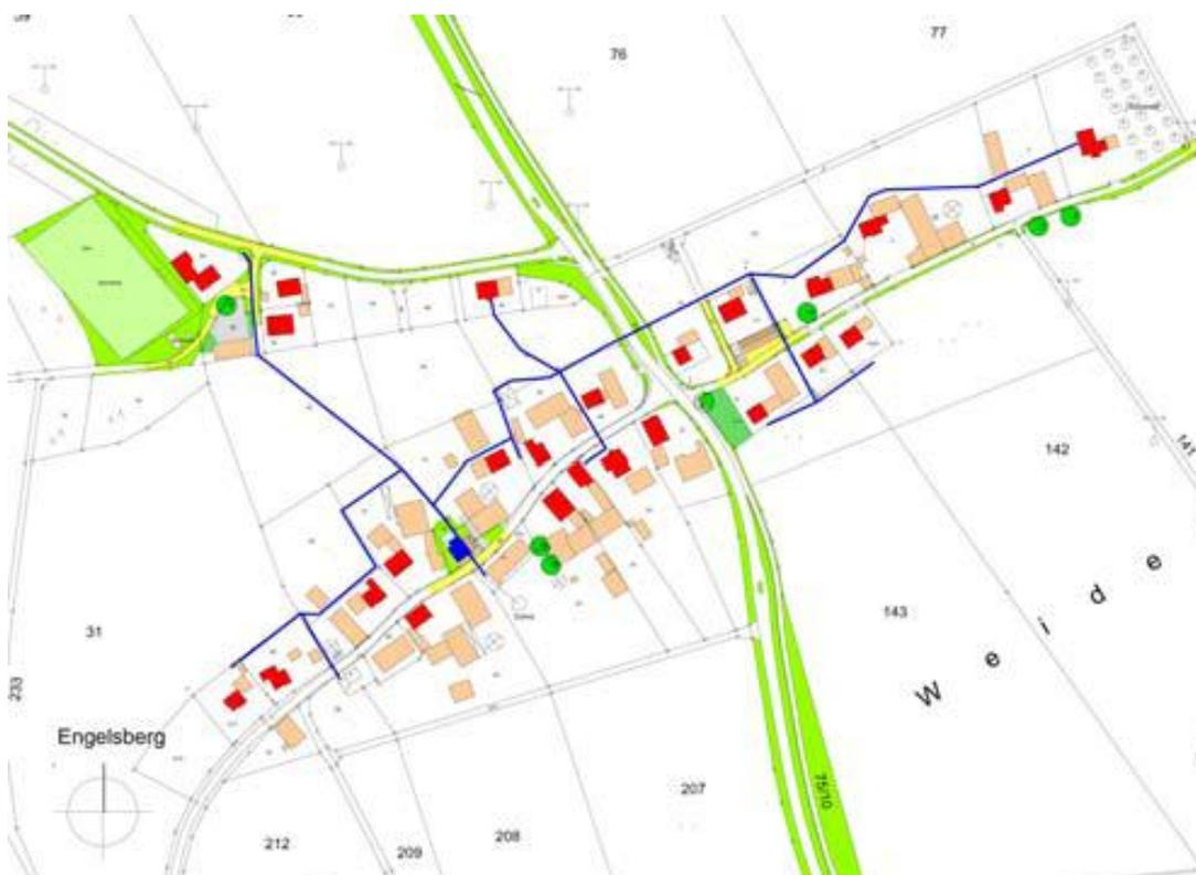
Abbildung 53: Der schematische Verlauf des Nahwärmenetzes
